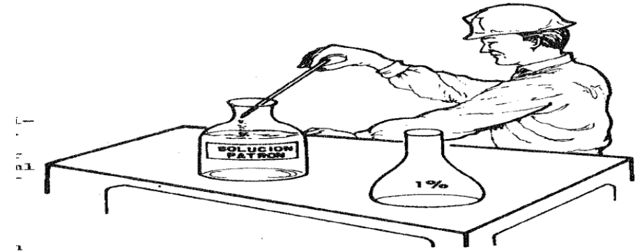
Figura 85. Preparando la solución de sulfato de aluminio
