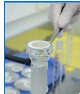
Extracción de un filtro con residuos luego de una filtración.
